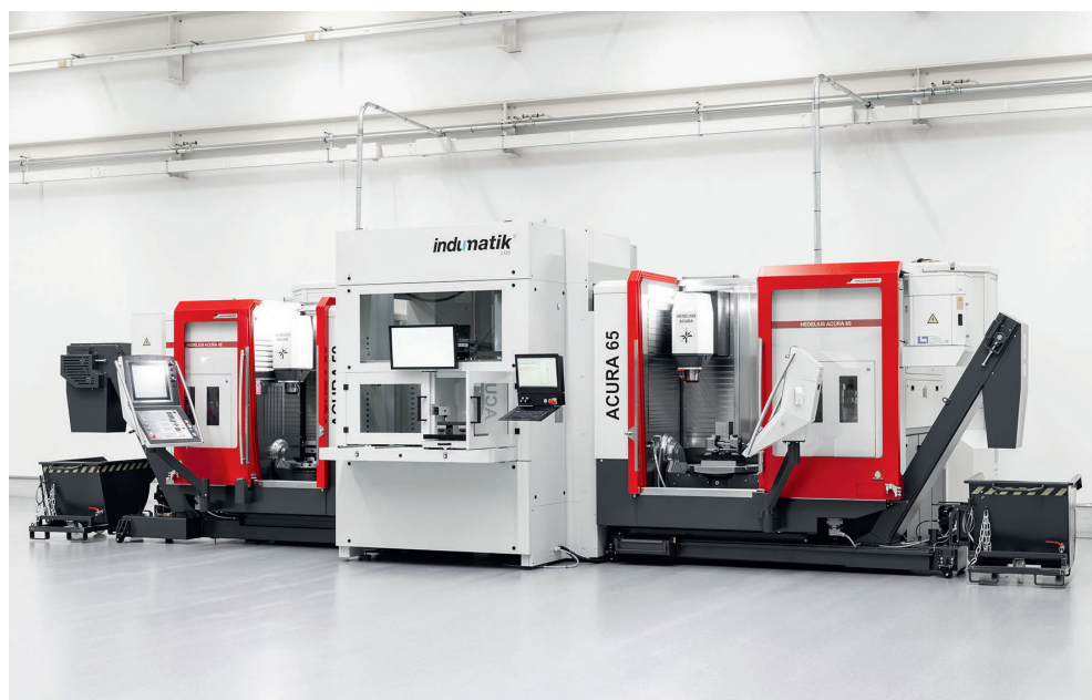
1 Mindestens eine Maschine läuft immer: Die Verkettungslösung für zwei 5-Achs-BAZ ›Indumatik Light 120‹ lässt im Automatikbetrieb Rüstarbeiten an einer Maschine zu © Hedelius
